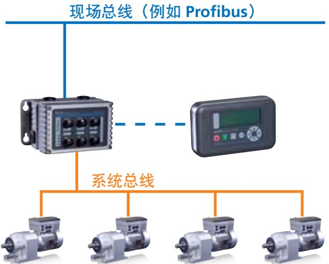
SK 200E 的总线技术单元为现场驱动系统提供了用户友好且经济的配置。鉴于技术单元设计了具有网关功能的总线系统，可同时为若干单元分配地址。通过标准的集成系统总线，可连接多达 4 个变频器和总线技术单元。因此，可通过一个点与主机总线系统连接，同时能够利用参数数据通道访问所有数据设置。可通过 RS 232 接口访问每一台相连的 SK 200E 设备和技术单元的数据。
